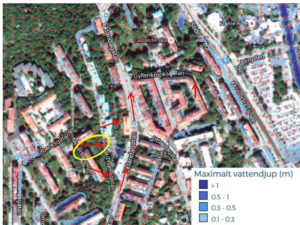
Figur 5. Skyfallsmodellering vid ett 100-årsregn. De mindre röda pilarna visar flödesriktning från modellen och de större röda pilarna visar vattnets ungefärliga flödesriktning i området. Gul linje visar ungefärlig placering av planområdet. Bild tagen från Stadsbyggnadskontoret i Göteborgs Stad.
